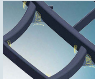
5軸シェイプ・オフセット仕上げ加工 のコーナー加工モード
