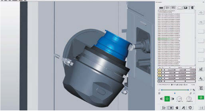
YENİ: hyperMILL SIMULATION Center ve sanal makinede, eksenle dönen geometriler şöyle gösterilir
