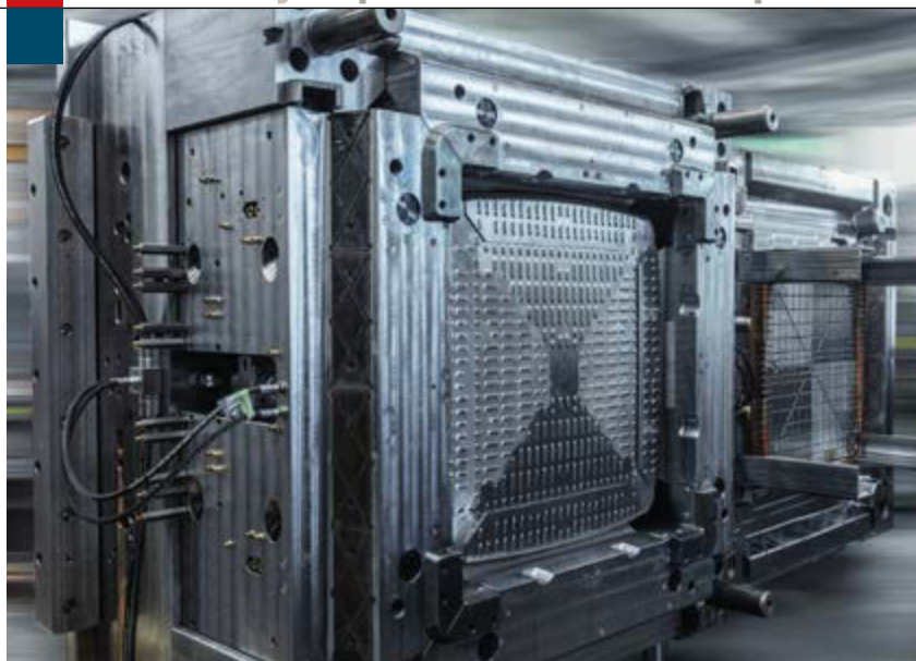
Stampo da 1.130 x 1.130 x 580h mm realizzato da Euro Stampi per produzione cassone agricolo da 630l
