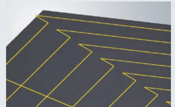
HFC-bewerking met hoekverplaatsingen: geen restmateriaal
